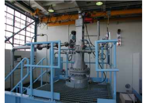
Les deux tours pressurisées procurent aux compagnies l'opportunité d'évaluer différentes configurations de procédés sous pression à étapes multiples comme par exemple, la delignification à l'oxygène.
