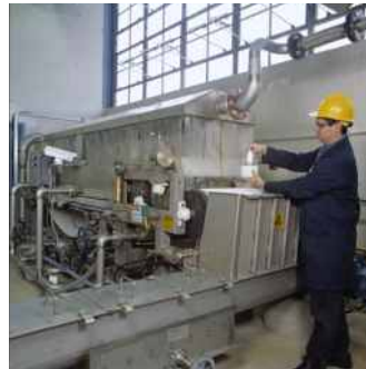
Le lessiveur à courroie qui utilise les filtrats entreposés dans l'ensemble des réservoirs assure l'application de scénarios de lavage réalistes.
